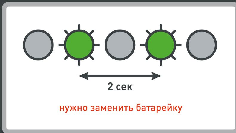
Если на радиометке каждые **2 секунды мигает** светодиод или при однократном нажатии кнопки на радиометке светодиод уже не мигает, то пришло время **заменить** в ней батарейку (батарейка CR2032).
